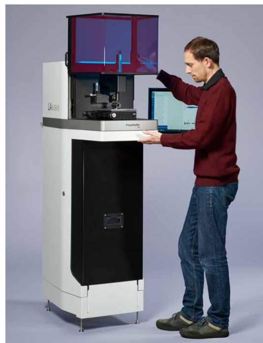
Das am Fraunhofer IWS entwickelte LAwave-Messsystem dient zur schnellen und zerstörungsfreien Charakterisierung von Schichten und Oberflächen. (© Jürgen Jeibmann/ Fraunhofer IWS)
