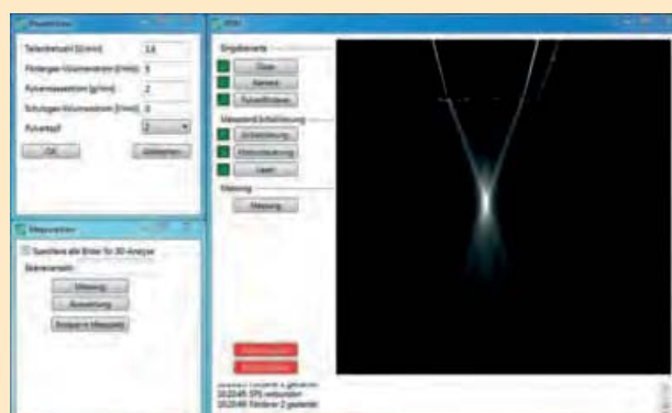
PC-basierte Auswertesoftware »PDM« zum Vermessen der Pulverströmung an Pulverdüsen für das Laser-Pulver-Auftragschweißen
