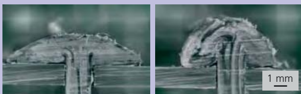
Querschnittsaufnahmen zweier umgeformter Faserverbundkunststoffstege
