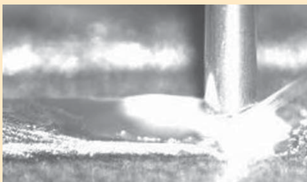
Prozess des koaxialen Laser-Draht-Auftragschweißens
