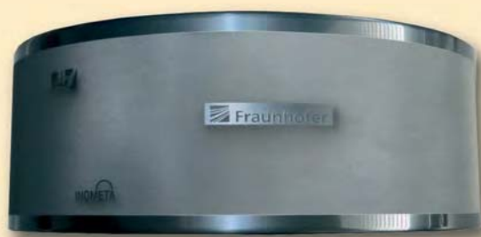
SHVOF- \text{Cr}_2\text{O}_3 -Beschichtung auf einer Aluminium-Welle, poliert, laserstrukturiert und lasergraviert
