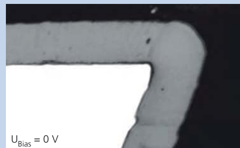
Querschliff einer Monolagenschicht, abgeschieden ohne Biasspannung (oben) und einer Mehrlagen-Hartstoffschicht, abgeschieden bei hoher Biasspannung (unten)
