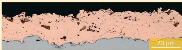
Schichtvergleich eines kommerziellen Kupferpulvers mit Aluminiumoxidpartikeln, hergestellt ohne (oben) und mit (unten) Laserunterstützung. Vorlaufend zum Spritzpartikelstrahl verbessert der Laserstrahl die Anbindung an das Substrat.
