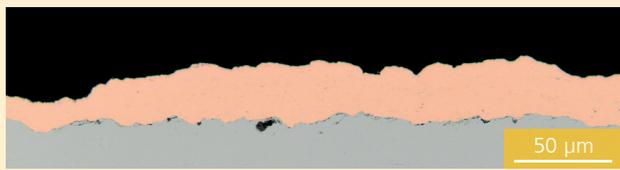
Überlappend und nachlaufend zum Spritzstrahl geführt ermöglicht der Laser die poren- und rissfreie Herstellung reiner Kupferschichten.
