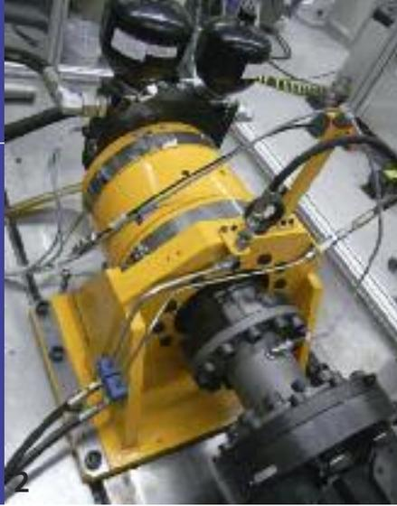
liche Anlage (Abb. 2) erlaubt die Durchführung von Betriebsfestigkeitsversuchen mittels gestufter Lastkollektive oder Einstufenversuchen bei überlagerten Zug- und Druck-Mittellasten. Als zeit- und kosteneffektive Variante für vergleichende Bewertungen der Schwingfestigkeit von Rund-Schweißnähten im Sinne einer Prozessparameter-Studie hat sich der Einsatz von Sonderverfahren (Treppenstufenverfahren oder Abgrenzungsverfahren) bewährt.
