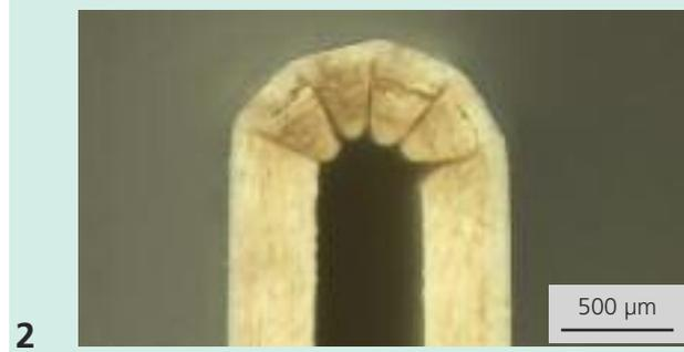
Das Aneinanderreihen mehrerer v-förmiger Linien gestattet einen minimalen Materialabtrag, welcher direkten Einfluss auf die Festigkeit und Stabilität der Verpackung hat. Die dadurch beeinflussbare Dehnung der Materialoberseite stellt sicher, dass die Oberseite nicht geschädigt wird (z. B. Reißen des Druckbildes).
