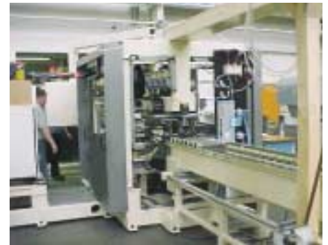
Anlage zum induktiv unterstützten Laserstrahlschweißen von PKW-Antriebswellen bei Visteon in Düren (Systemintegratoren Arnold und EMAG)
