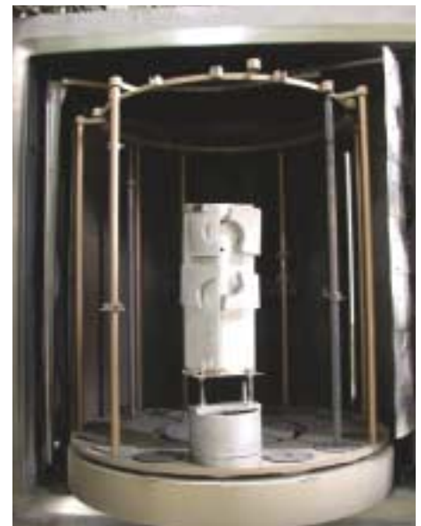
Abb. 3: Beschichtete Segmente eines achteiligen Umformwerkzeuges von TKS für die Umformung höherfester Stähle Größe der Segmente: 125 mm · 105 mm · 35 mm
