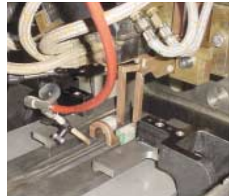
Abb. 1: Laserstrahlschweißkopf mit mitlaufendem Doppel-Linien-Induktor zur Beeinflussung des Temperaturfeldes
