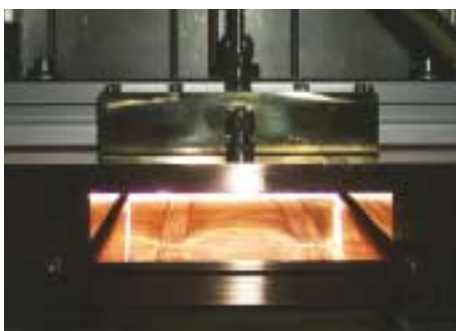
Blick in den Beschichtungsraum der ArcJet-PECVD-Anlage
