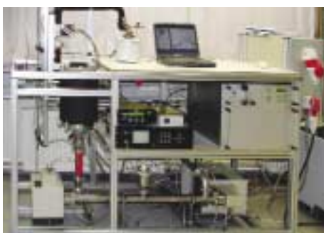
Abb. 2: Versuchsaufbau zur \text{SiO}_2 -CVD-Beschichtung mit integriertem FTIR-Gassensor
