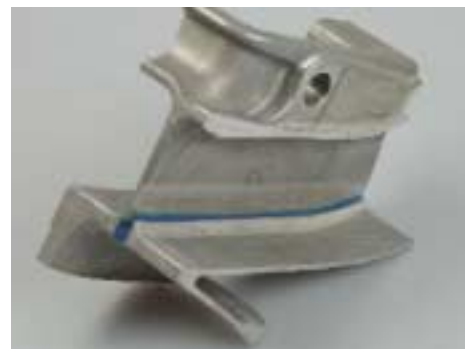
Abb. 3: Mit Laser vorbehandeltes und geklebtes Bauteil
