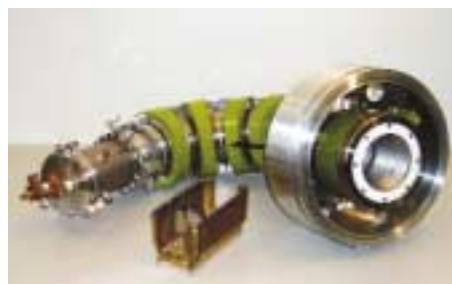
Abb. 3: Filtermodul zur Kohlenstoffbeschichtung von Festplatten
