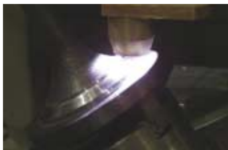
Abb. 2: Beschichtung von Großmotorenventilen durch PTA
