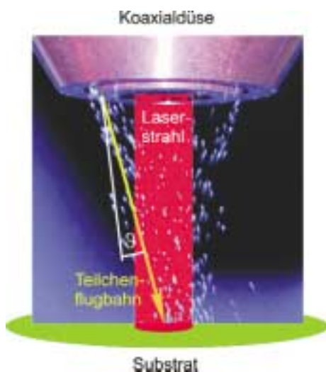
Abb. 1: Wechselwirkung von Pulverteilchenstrom und Laserstrahl bei einer Koaxialdüse (schematisch)
