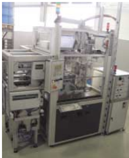
Laserstrahlhärteanlage bei der Fa. Sitec Industrietechnologie Chemnitz
