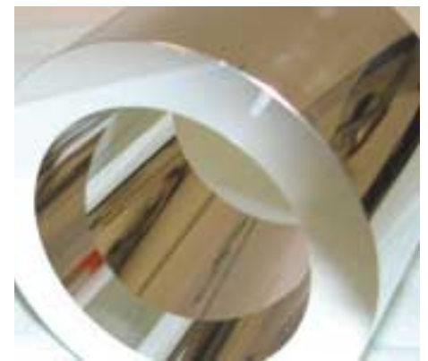
Abb. 2: Mittels PLD innenbeschichtete EUV-Kollektoroptik (Beschichtung: Molybdän + amorpher Kohlenstoff)
