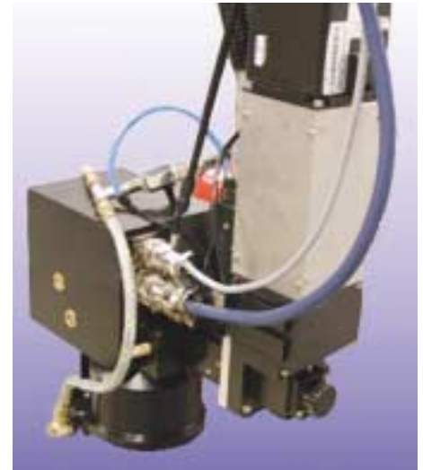
Abb. 1: Remote Welding System mit integrierter Prozessüberwachung
