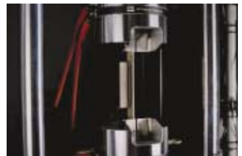
Schwingfestigkeitsprüfung von Laserhybridschweißverbindungen für den Stahlleichtbau
