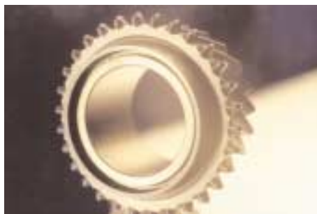
Laserstrahlschweißen eines Schaltrades für Pkw-Handschaltgetriebe, 16MnCr5 einsetzgehärtet
