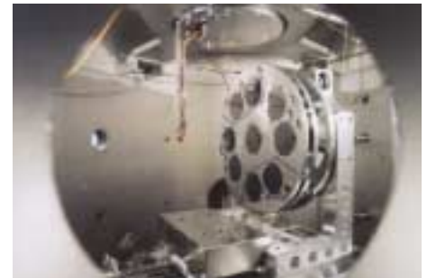
Abb. 2: Probenmanipulationssystem innerhalb der Goniometerkammer
