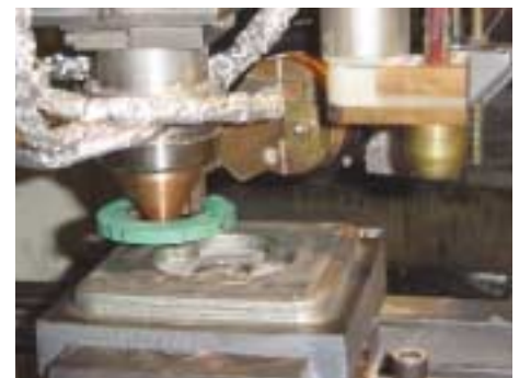
Abb. 5: Richtungsunabhängiges Auftragschweißen mit Induktor und Pulverdüse in konzentrischer Anordnung
