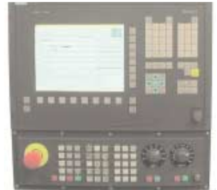
Abb. 2: Bedientafel OP010 einer Laserstrahlhärteanlage mit steuerungsintegriertem "LompocPro"
