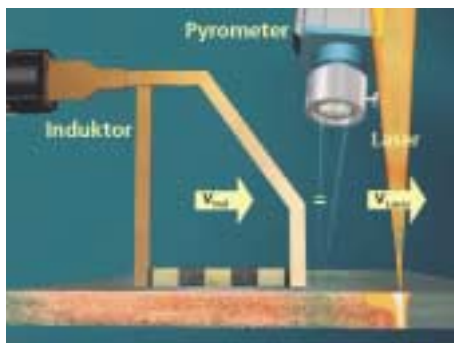
Abb. 3: Versuchsanordnung zum Laserstrahl-schweißen mit induktiver Nachwärmung
