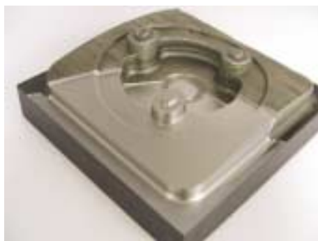
Abb. 2: Anwendungsbeispiel: Spritzgußformeneinsatz aus Stellite 21, direkt generiert durch Laser- und Plasmaauftragschweißen, teilbearbeitet
