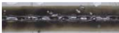
Abb. 1: Nahtoberraupe einer Laserschweißnaht im Überlappstoß (Überzug ZE 75/75, Nullspalt)
