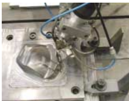
Abb. 3: Lokale 3D-Auftragschweißung mit Gelenkarm-Roboter auf ein Tiefziehwerkzeug
