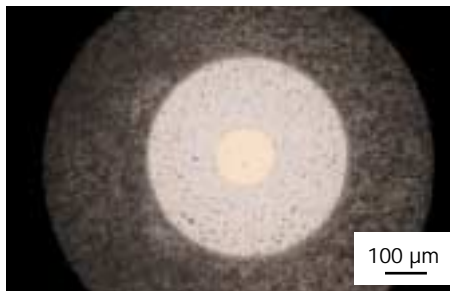
Abb. 1: Kalottenschliff zur Schichtdickenbestimmung einer 6,4 µm dicken Diamor®-Schicht
