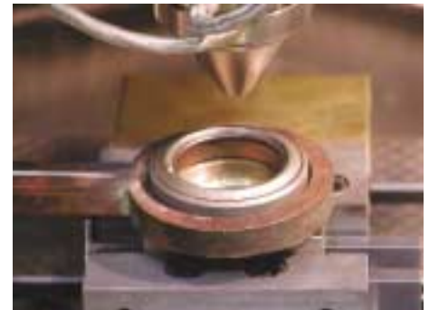
Abb. 4: Schweißaufbau zum induktiv unterstützten Laserstrahl-Auftragschweißen: Ring-Induktor und Koaxialpulverdüse am Beispiel eines Ventilrings
