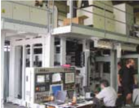
Laserstrahlschweißanlage zum Fügen von Differentialgetrieben (Systemintegrator Arnold)
