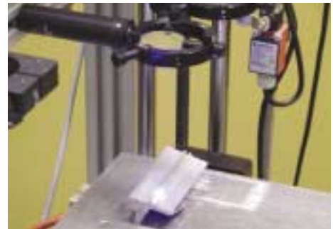
Abb. 2: Laserbehandlung eines Magnesiumbauteiles
