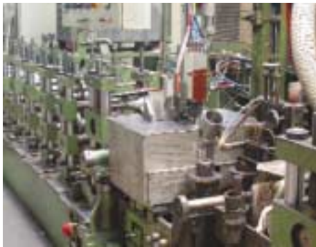
Anlage zum Schweißen von Edelstahlrohren in der Fa. Albrecht Zwick GmbH in Hagen
