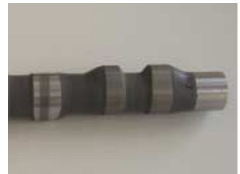
Abb. 2: Modellnockenwelle mit beschichteten und geschliffenen Nocken (Teilansicht)
