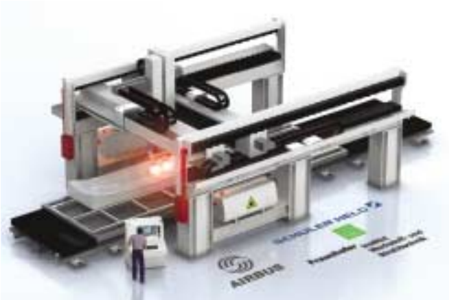
Abb. 1: Laseranlage für die Simultan- oder Tandem-Bearbeitung großformatiger Bauteile
