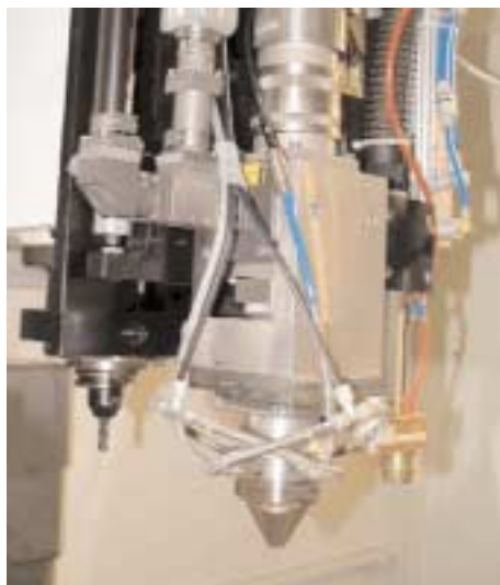
Abb. 1: Schweißaufbau zum Laser- und Plasma-Pulver-Auftragschweißen: Laser-Bearbeitungskopf und Plasma-brenner an Z-Achse einer Fräsmaschine
