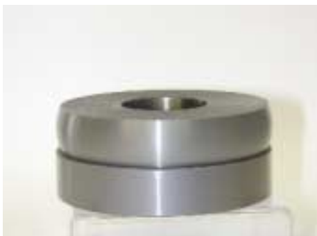
Abb. 2: Diamor®-beschichtete Stahlscheiben für Untersuchung des Wälzverschleißes mit Zweischeiben-Tribometer
