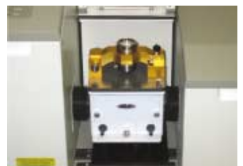
Abb. 3: ATR-Reflexionseinheit mit Diamantkristall
