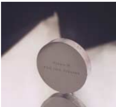
Abb. 1: Diamor® (Schichtdicke ca. 4 µm) auf Stahlrunde für Untersuchung des Reib- und Gleitverschleißes (Fretting-Tribometer)
