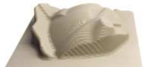
Abb. 5: Verteilung der Schnittebenen eines 3D-Modells auf eine 2D-Blechtafel und Ergebnis in Form eines aus Lammellen bestehenden Tiefziehwerkzeugs
