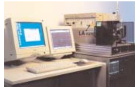
Laserakustik-Meßplatz LAwave® zur zerstörungsfreien Bestimmung der Eigenschaften dünner Schichten, in den USA mit dem "R&D 100 Award 2001" ausgezeichnet
