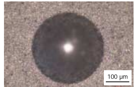
Abb. 2: Rockwell-Eindruck in einer 6,4 µm dicken Diamor®-Schicht. Die lichtmikroskopische Aufnahme lässt keine Risse oder Abplatzungen erkennen, daher Haftfestigkeitsklasse HF 1
