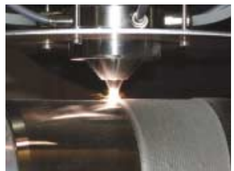
Laser-Pulver-Auftragschweißen des Verschleißringes eines Ölbohrwerkzeugs im Industrieinsatz
