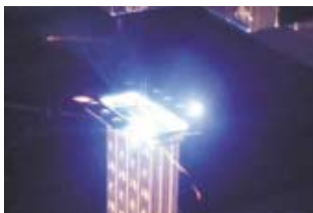
Schweißen der Rohr-Boden-Verbindung am Abgaswärmetauscher unter Nutzung einer Strahlableitoptik
