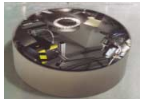
Abb. 3: Sphärischer Spiegel, beschichtet mit einer Mo/Si-Multischicht
