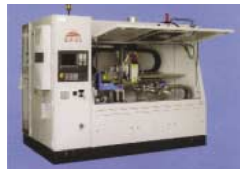
Abb. 3: Industrielle Laserstrahlhärteanlage des Herstellers EFD Induction GmbH Freiburg mit steuerungsintegriertem "LompocPro"
