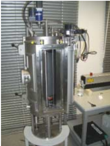
Abb. 1: Quellenkammer des Laser-Arc-Moduls, Blick durch den Rechteckflansch auf Kathodenwalze und Rundanode
