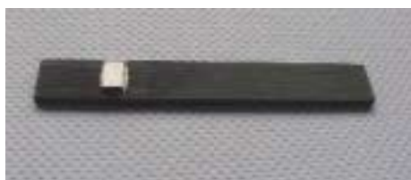
Abb. 1: C/SiC-Metall-Verbundprobe zur experimentellen Ermittlung der Scherfestigkeit
