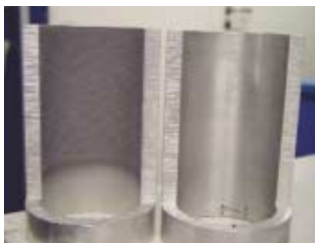
Abb. 2: Zylinderlaufbuchsen, links LAAPS beschichtet (Schichtdicke 400 µm), rechts unbeschichtet
