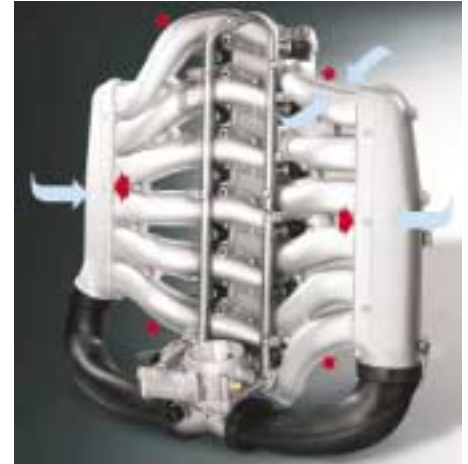
Abb. 1: Ansaugmodul eines 12-Zylinder-Motors aus Magnesium (AZ 91 HP)
