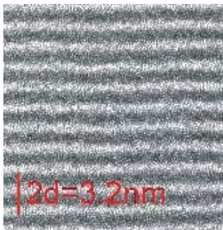
Abb. 2: TEM-Querschnitt einer Cr/Sc-Multischicht mit einer Periodendicke von d_{\text{Periode}} = 1,58 nm
