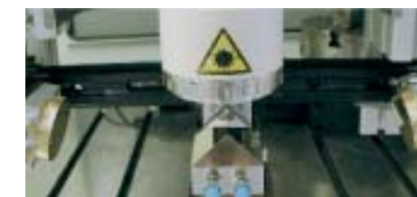
Abb. 1: Strahlteileroptik für Hochleistungsdiodenlaser (Laborsystem)
