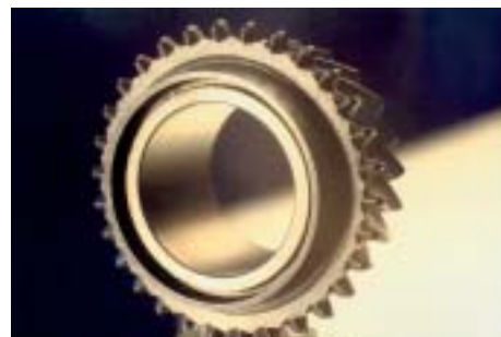
Laserstrahlschweißen eines Schaltrades für Pkw-Handschaltgetriebe, 16MnCr5 einsatzgehärtet
