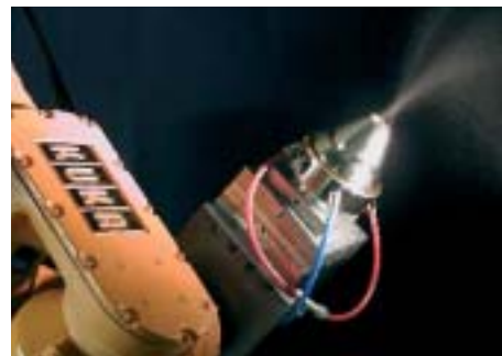
Abb. 2: KOAX 10, kombiniert mit Gelenkarmroboter, zum Beschichten von Freiformflächen
