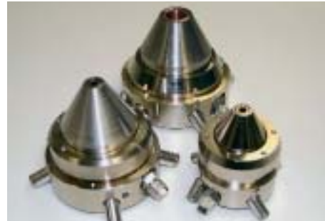
Abb. 1: Pulverdüsenentwicklung, KOAX 8 (links), KOAX 9 für Nd:YAG (rechts), KOAX 10 für Diodenlaser (hinten)
