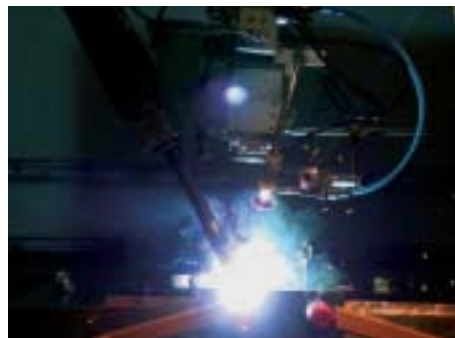
Abb. 2: Hybridschweißprozess an Ecknähten
