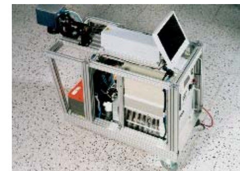
Abb. 2: Prototyp der mobilen Anlage zur rutschhemmenden Ausrüstung polierter Fußbodenbeläge
