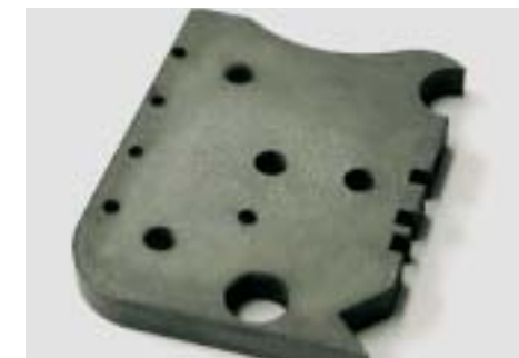
Abb. 2: Härteprozess-Testkörper, enthält Problemgeometrien wie konkave und konvexe Krümmungen, spitzwinklige Ecken, Bohrungen und Stege
