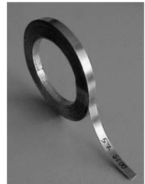
Abb. 2: Mittels Rascherstarrung hergestelltes Band, Bandbreite 5 mm, Werkstoff AlSi12
