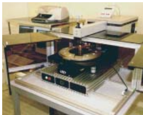
Abb. 2: Laserakustisches Prüfgerät für 300-mm-Wafer
