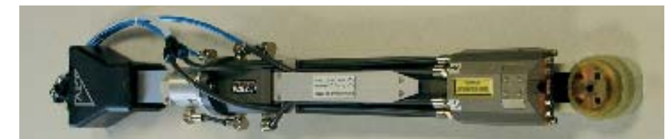
Abb. 2: Gesamtansicht des Beschichtungskopfes, bestehend aus 20 kW Plasmabrenner, Nd:YAG-Laseroptik und integrierten Medienzuführungen
