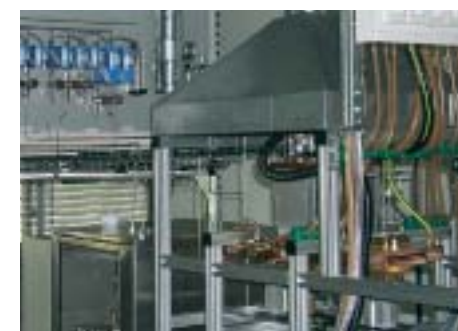
Arcjet-CVD-Anlage zur quasi-kontinuierlichen Beschichtung (30 kW DC-Arc-Quelle)
