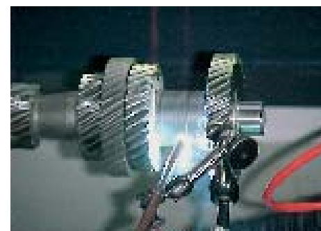
Abb. 3: Laserschweißprozess einer Radialrundnaht im Laborbetrieb
