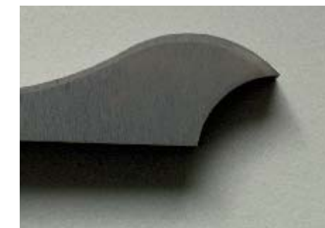
Abb. 3: Ergebnis der Optimierung an einer gekrümmten, spitzwinkligen Bauteillecke. Deutlich sichtbar ist die konstante Einhärtetiefe trotz stark absinkender Wärmeableitung
