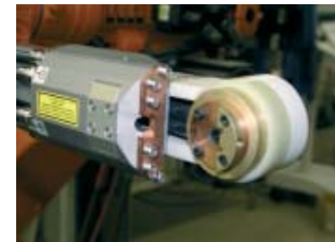
Abb. 1: Detailansicht von Plasmakopf und Laserstrahl-Austrittsfenster mit Cross-Jet
