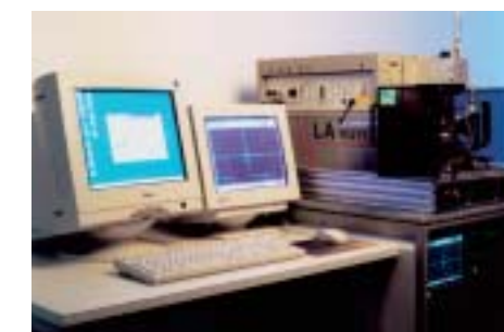
Laserakustik-Meßplatz LAwave® zur zerstörung- sfreien Bestimmung der Eigenschaften dünner Schichten, in den USA mit dem "R&D 100 Award 2001" ausgezeichnet
