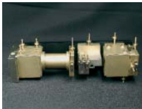
Abb. 2: Hochbrillanter kollimierender Monochromator zur Erzeugung eines sub-Millimeter-Röntgenpunktstrahls
