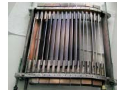
Abb. 1: Filtermodul für industrielle Vakuumbogen-Beschichtungsanlagen. Der Filter kann an verschiedene Typen von Bogenverdampfern angepasst werden.
