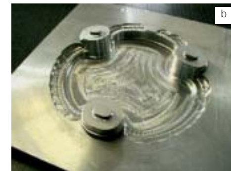
Abb. 2: Al-Modell, a) mit LPA generiert b) mechanisch überarbeitet
