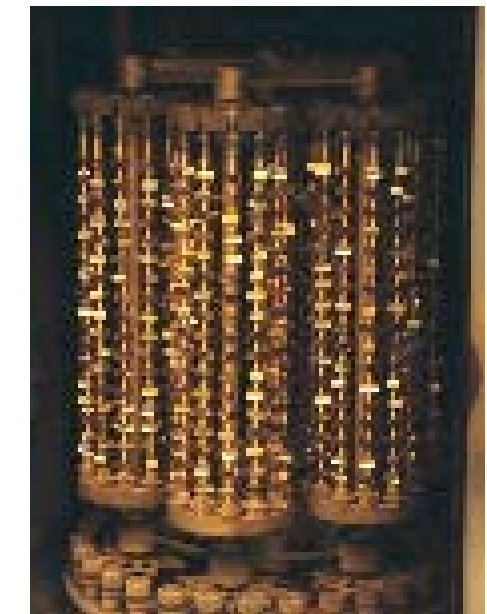
Abb. 2: Mit Wendeschneidplatten beladene Beschichtungskammer
