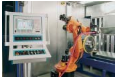
Abb. 1: Anlage zum atmosphärischen Plasmaspritzen in einer Schallschutzkabine mit Vorrichtung zum Wellenhandling und 6-Achs-Roboter
