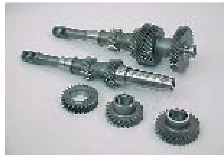
Abb. 1: Antriebswelle eines 6-Gang-Pkw-Getriebes unten: Einzelteile oben: gefügter Zustand
