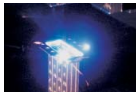
Schweißen der Rohr-Boden-Verbindung am Abgaswärmetauscher unter Nutzung einer Strahlablensoptik
