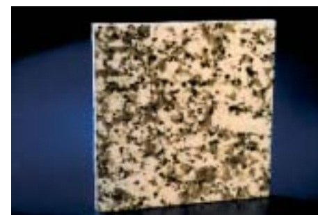
Rutschhemmende Ausrüstung polierter Fußbodenbeläge durch Lasermikrostrukturierung
