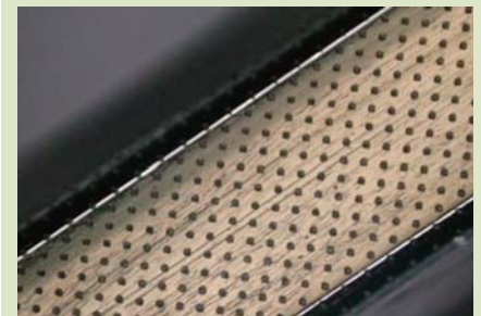
Tribologisch wirksame Lasermikrostrukturen auf einer Motorenkomponente
