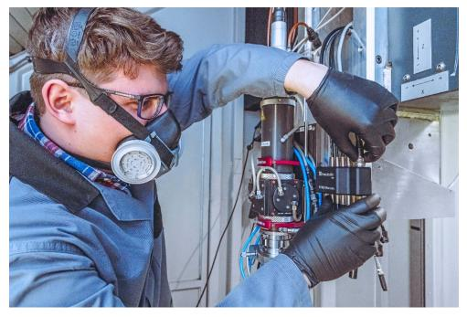
Ein besonderer Vorteil ist die universelle Einsatzfähigkeit: Der POWDERscreen lässt sich an jeden Prozesskopf für das Pulver-Laserauftragschweißen montieren.
