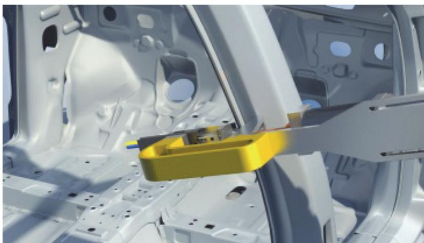
**Das HPCI-Verfahren kommt bei der Integration von Faserverbundbauteilen in metallische Karosseriestrukturen zum Einsatz.**
