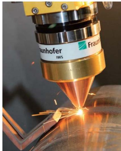
Laser-Auftragschweißen mit einem COAX-Laser-Bearbeitungskopf
