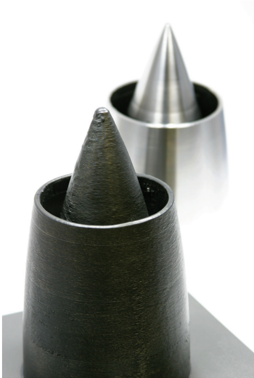
Generieren einer Expansionsdüse durch Laser-Draht-Auftragschweißen © Fraunhofer IWS Dresden
